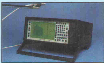
Das kompakte Brüel & Kjær 2144 eignet sich für akustische, elektroakustische und Vibrationsmessungen.
